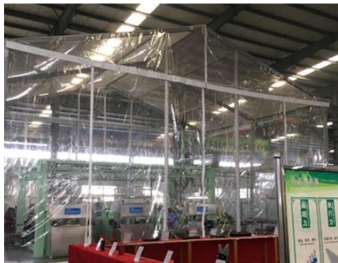
图10 发泡区域密闭收集示意图
